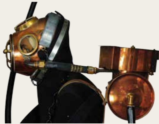
Appareil-plongeur Rouquayrol-Denayrouze, modèle 1864, 8 l. © Collection musée du Scaphandre, Espalion
